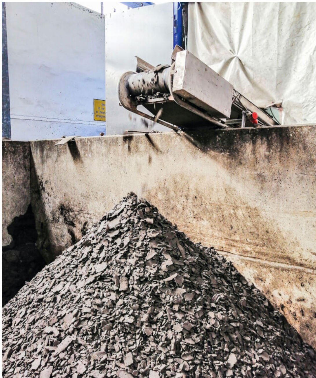
Der entwässerte Bohrschlamm wird im Deichbau als Ersatz für Kleiboden eingesetzt. | Foto: Kahnenbley
